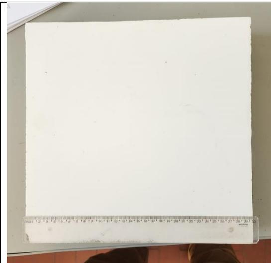
**FIGURA 01** – Amostra do painel de fechamento com dimensão de 30 x 30 cm.
