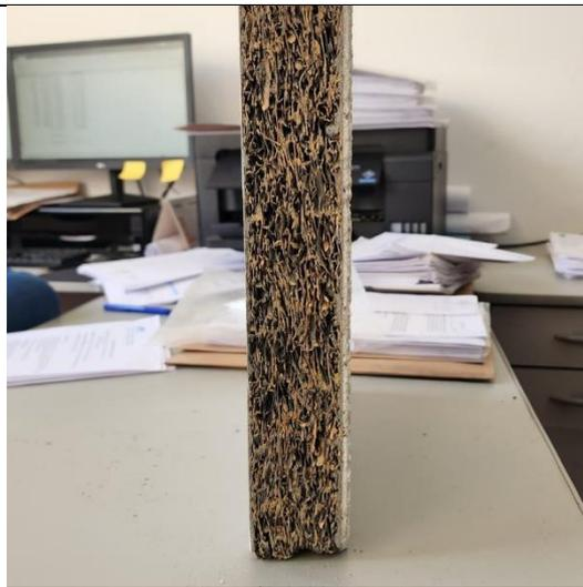
**FIGURA 02** – Fotografia em corte do painel de fechando, demonstrado a madeira mineralizada em seu interior.
