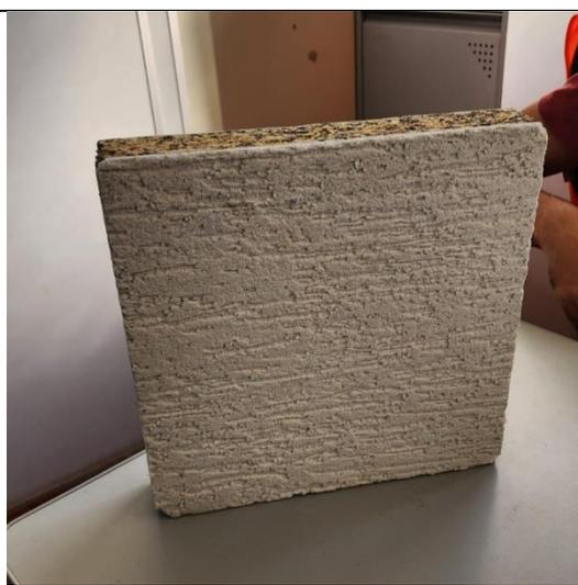
**FIGURA 04** – Perfil de acabamento externo em textura rugosa.
