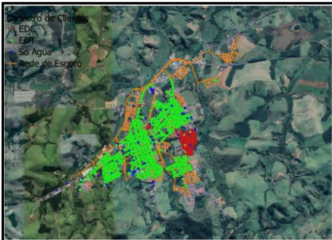
Figura 60 - Cadastro do Sistema de Esgotamento Sanitário de Borda da Mata.
