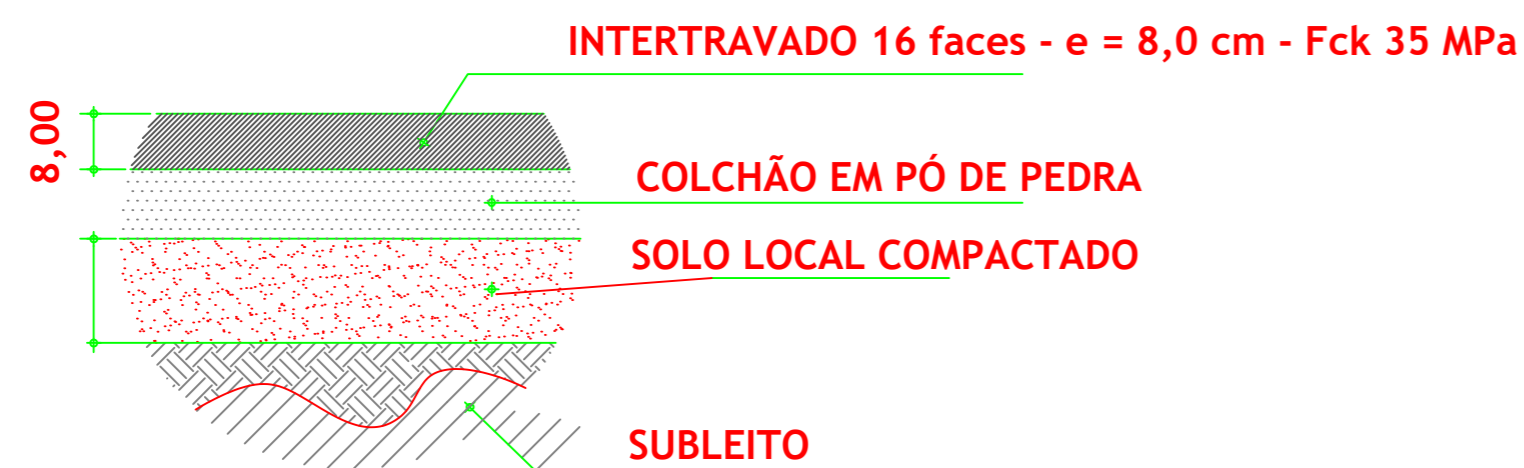
DETALHE 01: CORTE - CAMADAS BLOQUETE S/ ESCALA
